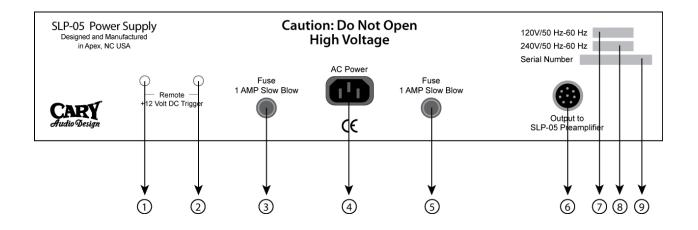
1. REMOTE TRIGGER +14 VOLTS FOR POWER AMPLIFIERS
